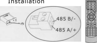
Collegare al connettore rs 485 il cavo della rs 485 controllo PTZ proveniente dalla speed dome, Collegare al connettore DC12V L'alimentazionet.
